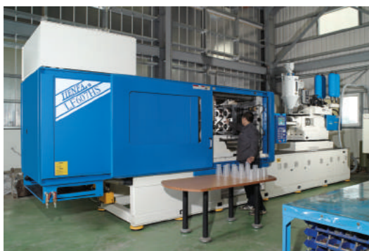
LF607HS 高速氮氣加壓射出成型機 1250 X 1200mm LF607HS 1250 x 1200 mm
